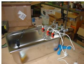
Baño termostático diseñado y producido en el PIE
