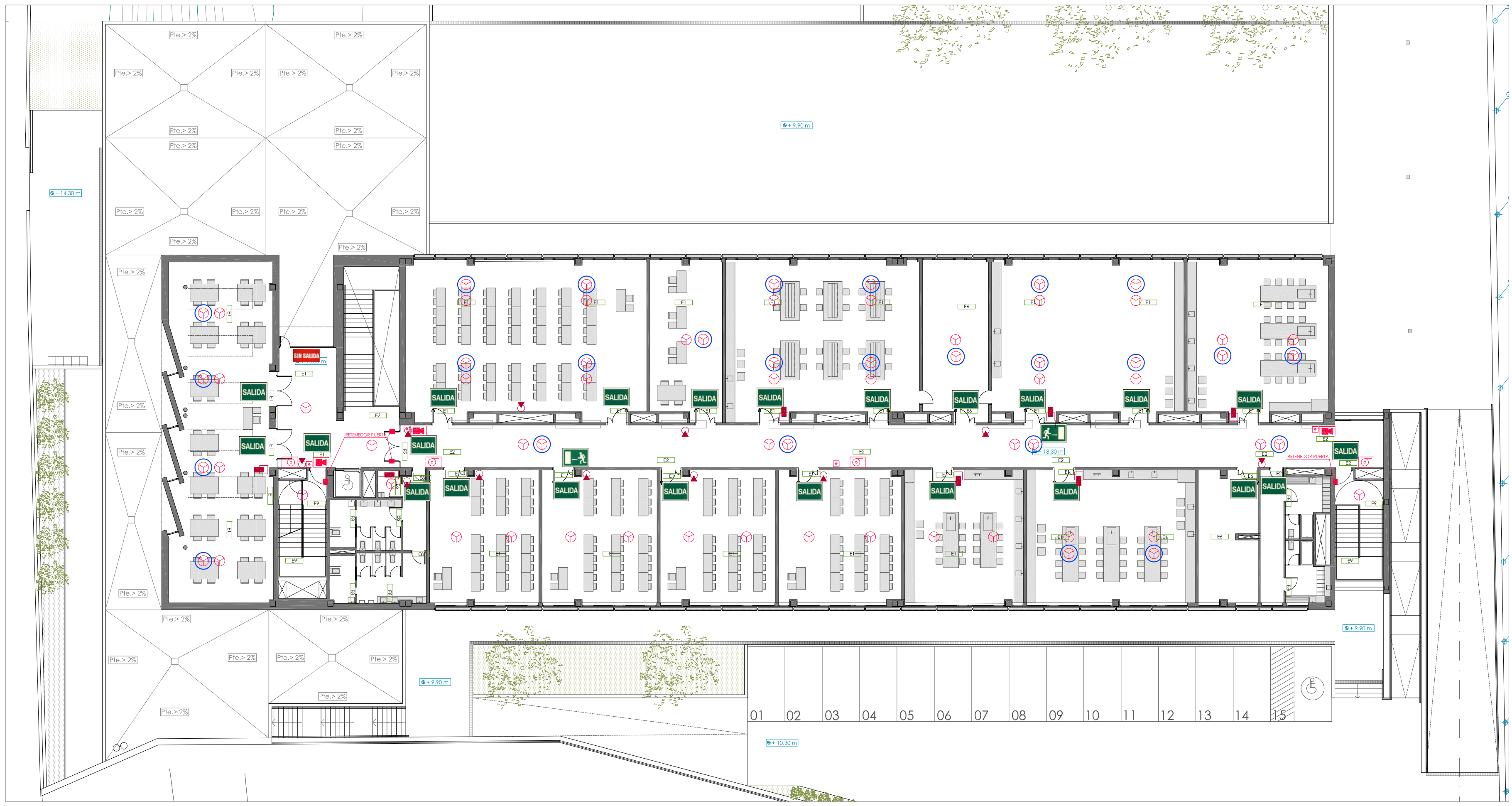
PLANTA NIVEL + 18.30 SISTEMAS DE DETECCION Y EXTINCION DE INCENDIOS. SEÑALIZACION
