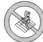
PROHIBIDO PISAR SUELO NO SEGURO
